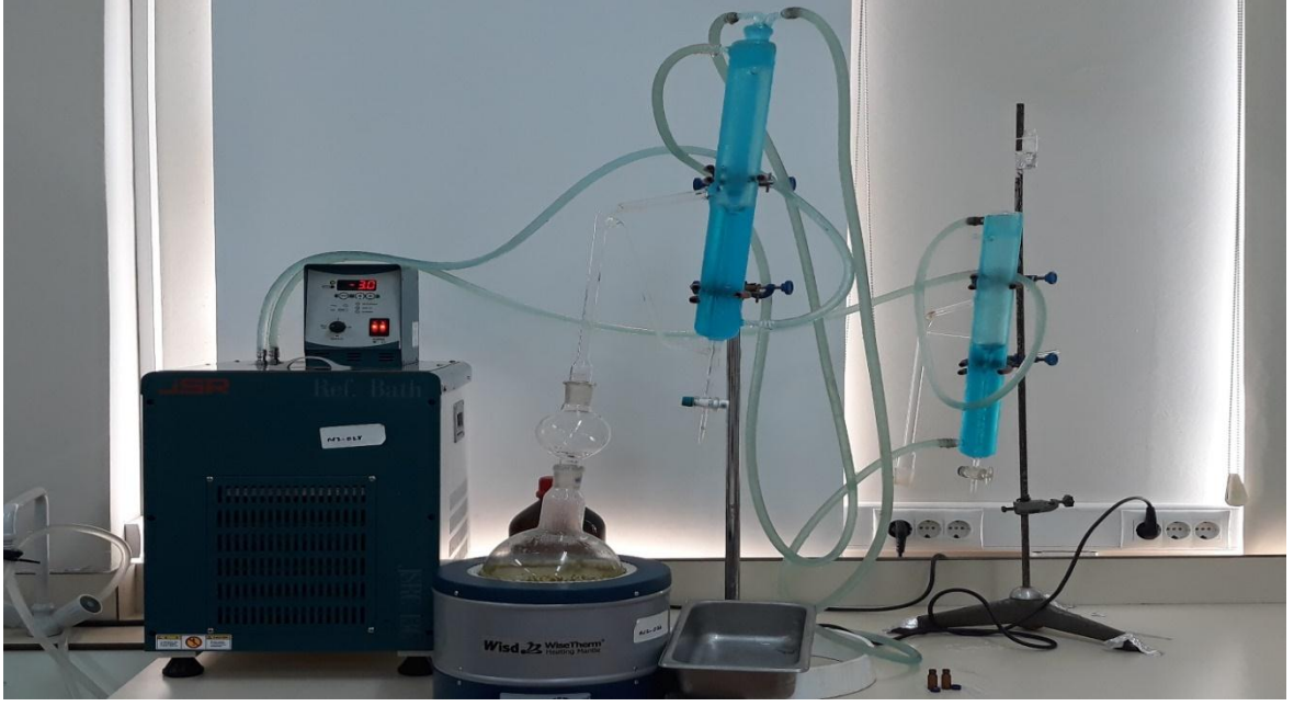
Şekil 2.3. Çalışmada kullanılan Clevenger düzeneği
